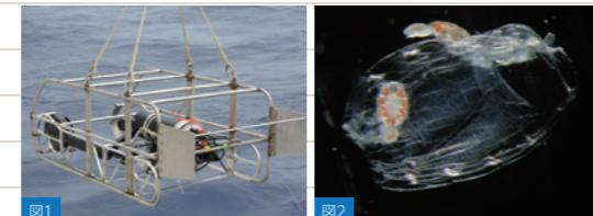
図1 現場型プランクトン撮影装置
